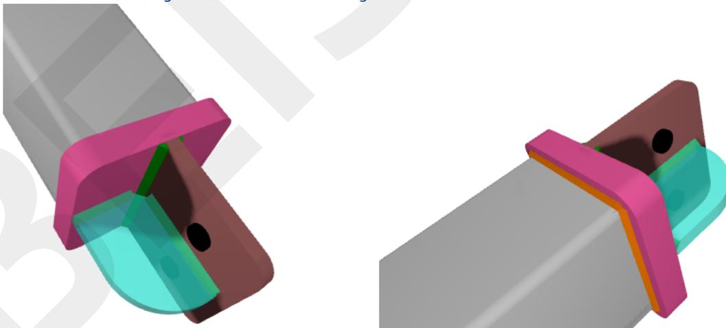
Die Zwickel sind durch zwei Schrauben (und gehärtete Unterlegscheiben) miteinander verbunden, die durch einfaches Abscheren funktionieren.
